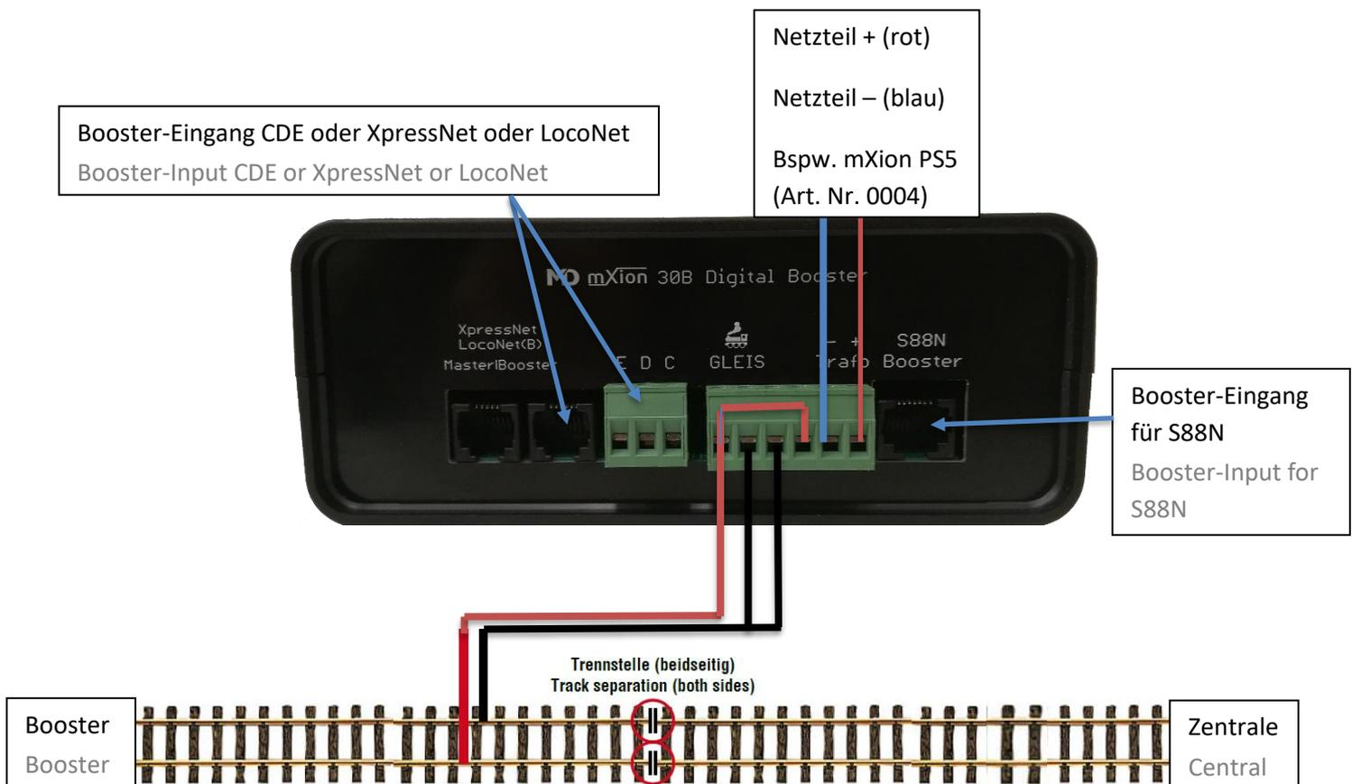
Nutzen Sie immer nur eine Einspeisemöglichkeit des Boosters (bspw. Signaleingang CDE ODER LocoNet-Booster Eingang ODER Signaleingang S88N ODER Signaleingang XpressNet (Booster)). Wenn Ihre Zentrale keins der oben aufgeführten Schnittstellen hat um Booster speisen zu können, können Sie entweder unseren B-Bus/CDE/XpressNet Verteiler (Art. Nr. 0017) nutzen, oder direkt den Fahrstrom, also den Gleisanschluss Ihrer Zentrale mit dem C & D-Eingängen verbinden (siehe nachfolgendes Bild).
