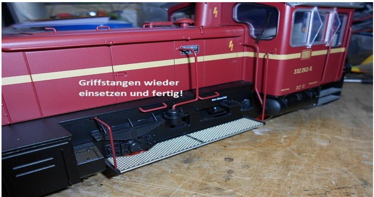
Nach erfolgreicher Probefahrt und Tests kann das Gehäuse festgeschraubt werden und die Griffstangen wieder montiert werden. Somit ist der Umbau abgeschlossen und die Lok kann wieder dem Betriebsdienst übergeben werden.
